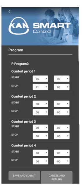
Wybieramy czas utrzymywania temperatury komfortowej, podczas gdy system reguluje żądaną temperaturę komfortową. Na każdy program ogrzewania przypadają 4 okresy utrzymywania temperatury komfortowej.
