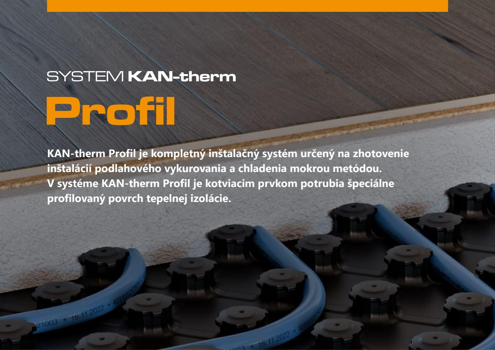
Konštrukcia podlahového vykurovania z prvkov systému KAN-therm Profil je súčasťou systémov podlahového vykurovania zhotovovaných mokrou metódou. Prvkom upevňujúcim vykurovacie rúrky sú špeciálne profilované plastové alebo polystyrénové výstupky umiestnené na povrchu tepelnej izolácie.
