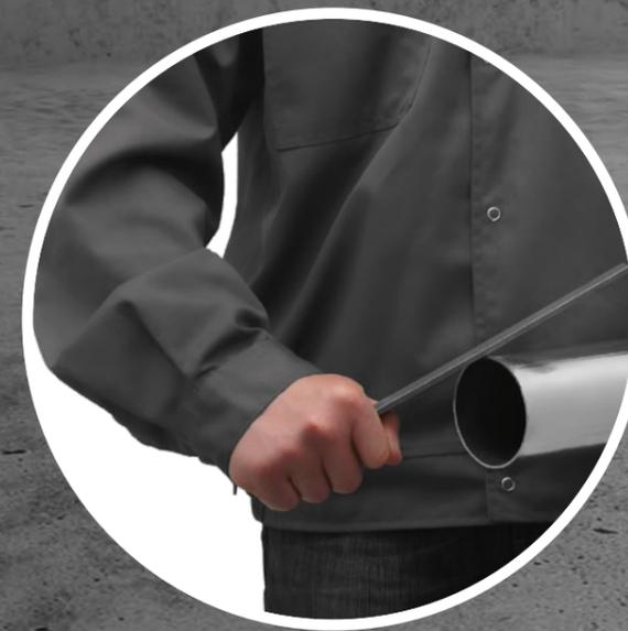
**02** | Odhrotovanie vonkajšieho a vnútorného povrchu rezu rúrky pomocou špeciálnych odhrotovačov (pre rúrky s priemerom do 54 mm) alebo ocelových pilníkov (pre rúrky s priemerom nad 54 mm).
