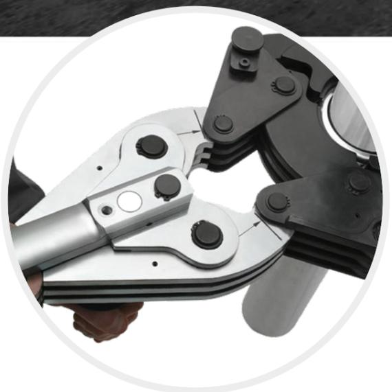
**09** Pripojenie čeluste k lisovacím kliešťom pred lisovaním.
