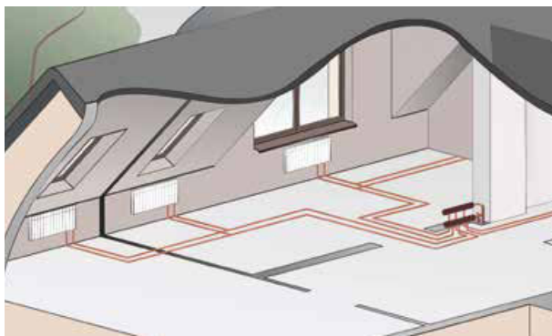
Horizontálno-hviezdicová vykurovacia sústava.
