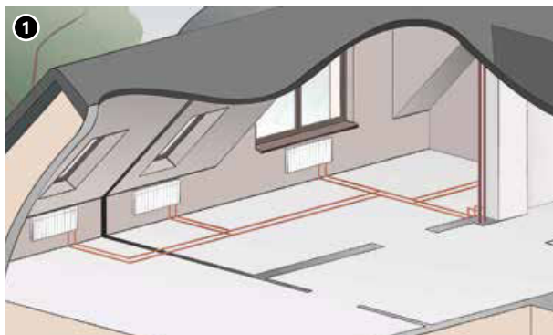
1. Horizontálna vykurovacia sústava.
