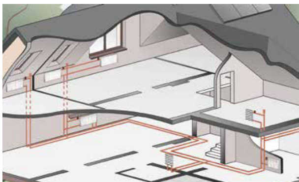
Vertikálna vykurovacía sústava.
