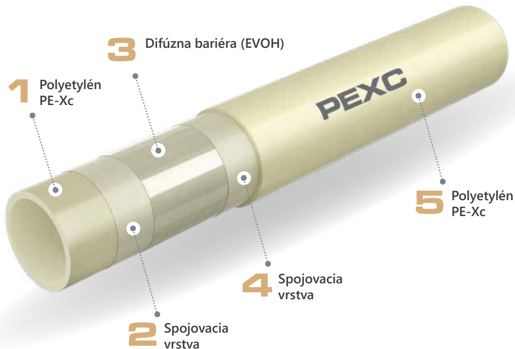
Prierez rúrky PEXC s antidifúznou fóliou
